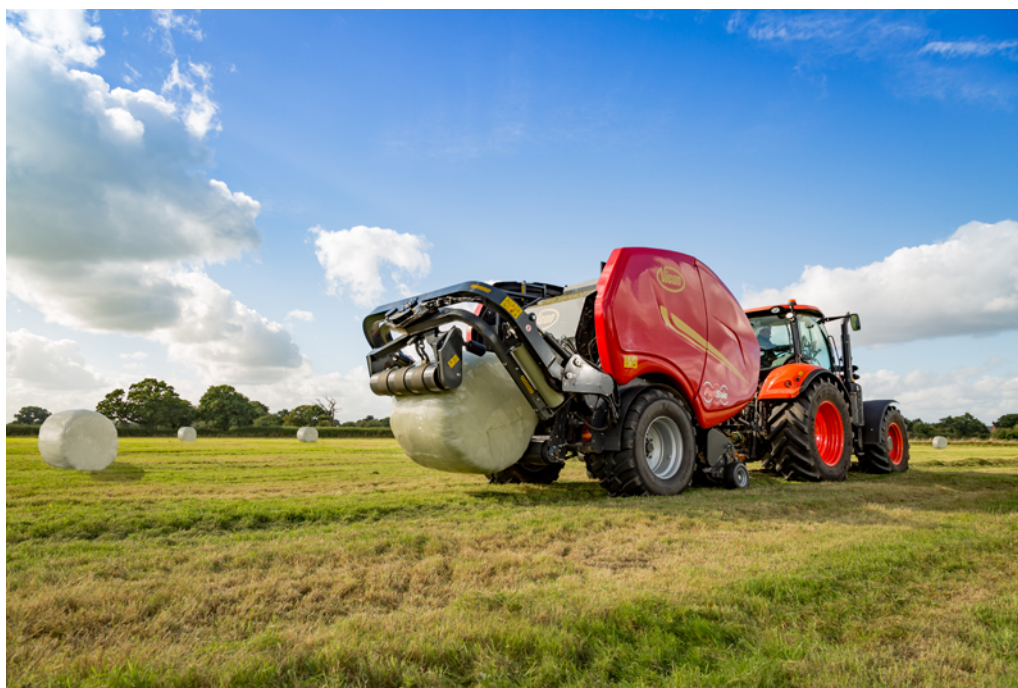
Vicon FastBale Non-Stop combinazione di rotopressa e fasciatore
